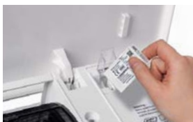
Kinderleichte WLAN-Anbindung per WiFi-Modul
